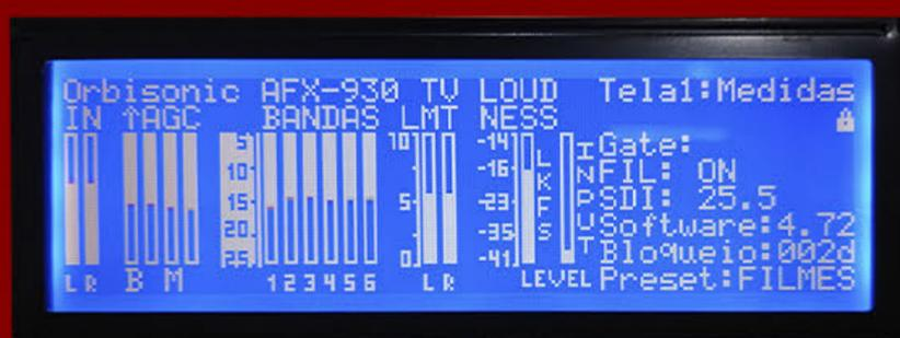
Interface através de um painel LDC com todos ajustes e controles disponível no painel frontal.
